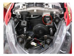
SMAX 繼電器需將大盾以|勁戰三代繼電器需拆除龍|勁戰四代繼電器須拆除 H 及 H 殼拆下,位於儀表板頭左右殼,位於龍頭內部 | 殼,位於 H 殼左下方 下方
